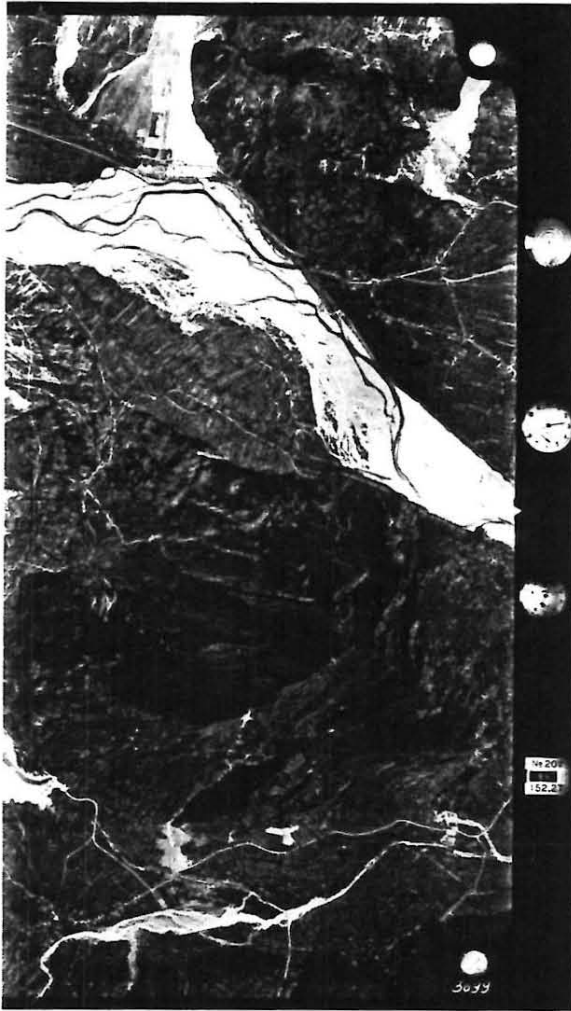
Figura 2. Visione parziale di una foto con alcuni suoi elementi caratteristici: a sinistra, la croce in colore individua il punto principale; a destra, sul bordo del fotogramma sono visibili, procedendo dall'alto verso il basso, una livella a bolla centrale, un orologio (indicante l'ora della ripresa), un altimetro (indicante la quota di volo: 5.070 m) ed una targhetta con il numero della camera (N° 207), il numero del fotogramma (3699) e la distanza focale dell'obiettivo (152,27 mm). (Autorizzazione alla pubblicazione dell'I.G.M. n. 765 in data 13.7.1974.)
